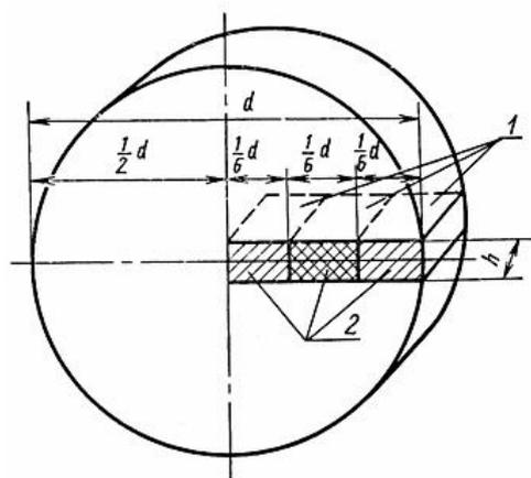
1 - образцы для испытаний; 2 - плоскости шлифов
