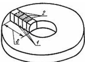
1 - образцы для испытания; 2 - плоскости шлифов
