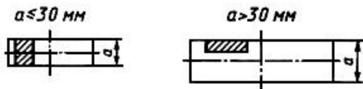
Рисунок Д.5 - Схемы отбора проб от листового и широкополосного проката
